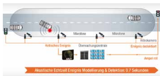
Abbildung: Funktionsweise des Akustischen Tunnelmonitorings - AKUT
